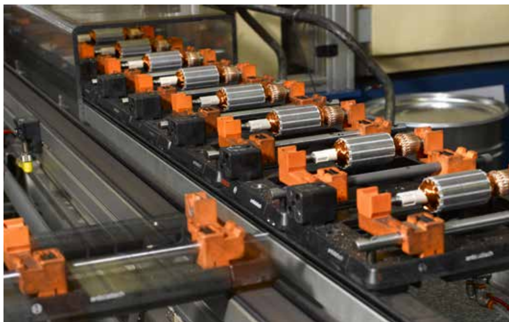
Onderdeel van de Marathonmotor van Metabo. Deze motor is zo ontworpen dat hij extra bescherming biedt tegen stof en vuil.
