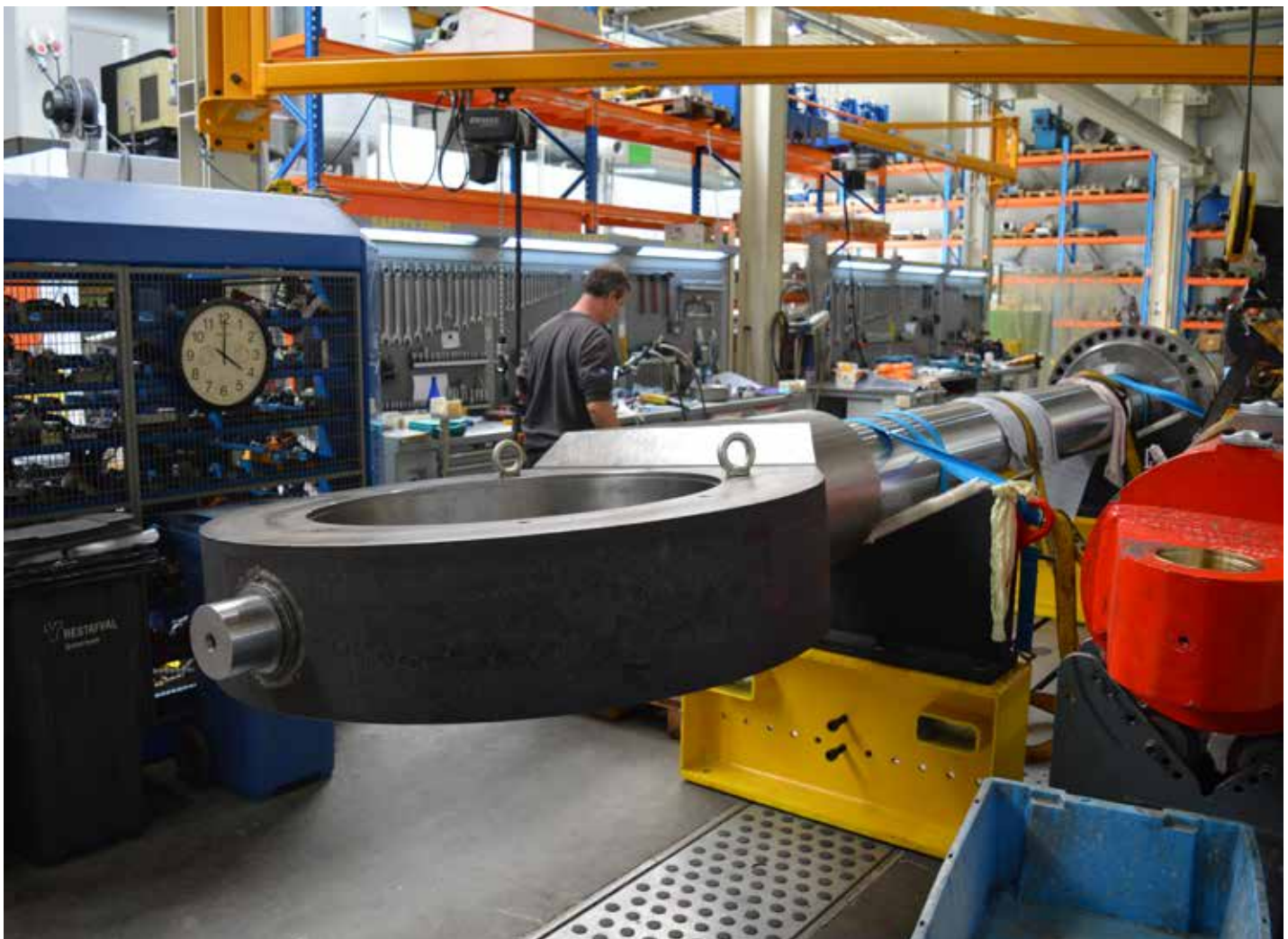
Hydraulische cilinder voor een sluis: Hydrauliek Morreels kan gemakkelijk grote opdrachten aan. De zaakvoerders hechten bovendien veel belang aan een propere en gezonde werkomgeving.
