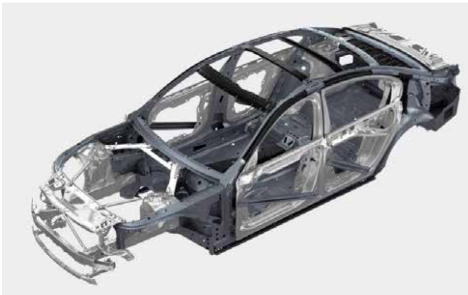
Car body BMW 7 series: Designers integreren clinchverbindingen bij het ontwerp
