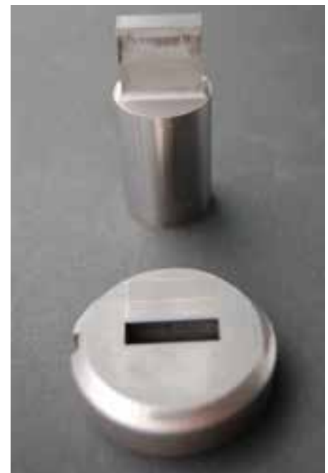
Boven: conventioneel geharde stempel na 8500 slagen. Onder: geharde en diepgekoelde stempel na 10000 slagen
