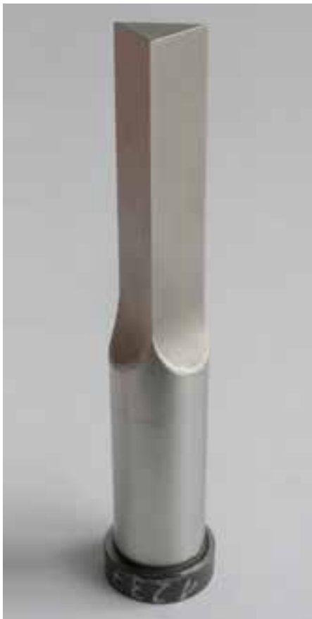
Voorbeeld van een driehoekige stempel gebruikt voor de ponstesten op laboschaal
