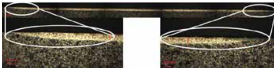
Doorsnede van een ander testmonster in C45-staal, met "power shaping": aan de zijkant is er geen smelt noch witte laag zichtbaar, terwijl de scanbreedte van 18 mm constant blijft. Uit de XRD-analyse blijkt een zeer fijne microstructuur, met normale drukspanningen lager dan 500 MPa en afschuifspanningen van ongeveer 80 MPa. De opgemeten distorties en dimensionele afwijkingen zijn verwaarloosbaar.
